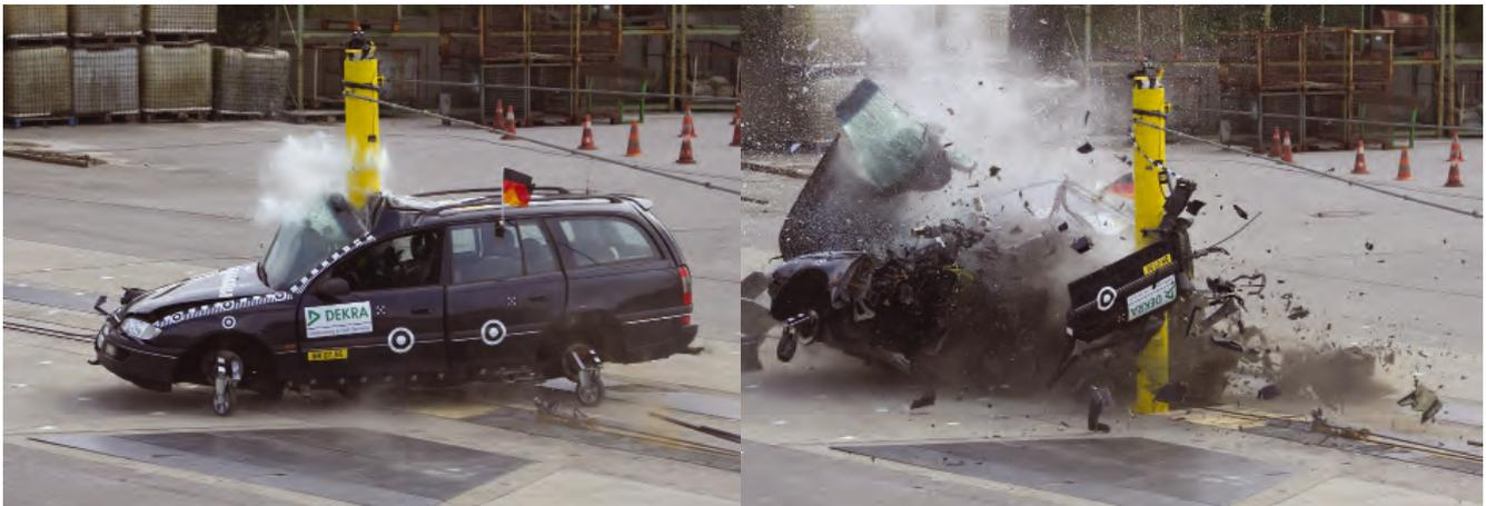
**Bild 7: Pfahlanprall mit 97 km/h eines Opel Omega B Baujahr 1994 unter einem Winkel von 23° und einem Versuchsgewicht von 1.656 kg. [5]**
