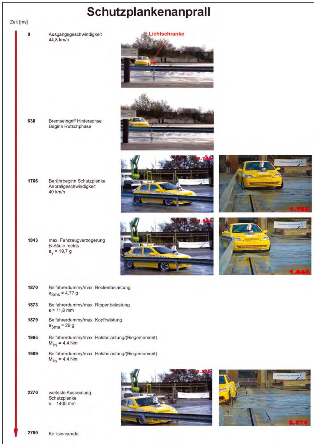
Bild 6: Versuchsablauf mit Schutzplanke
